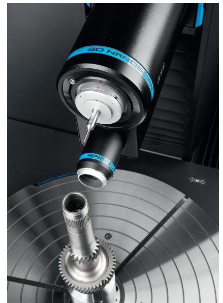
2 Optische Messoption mit Hispeed Opto-scan für eine hohe Informationsdichte
